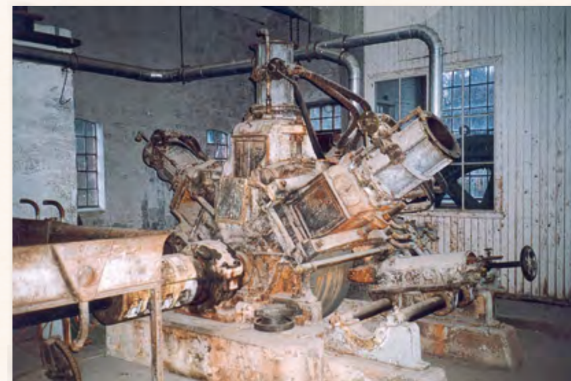
Skrankefoss hadde to Myrens ileggsapparater koblet til samme turbinaksling.
